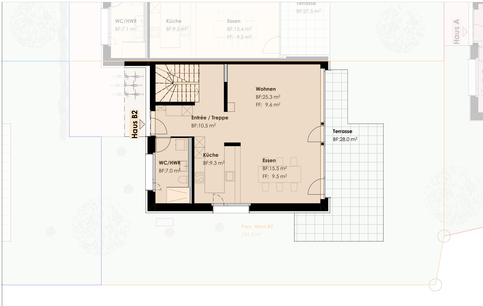
Haus B2 Grundriss Erdgeschoss
